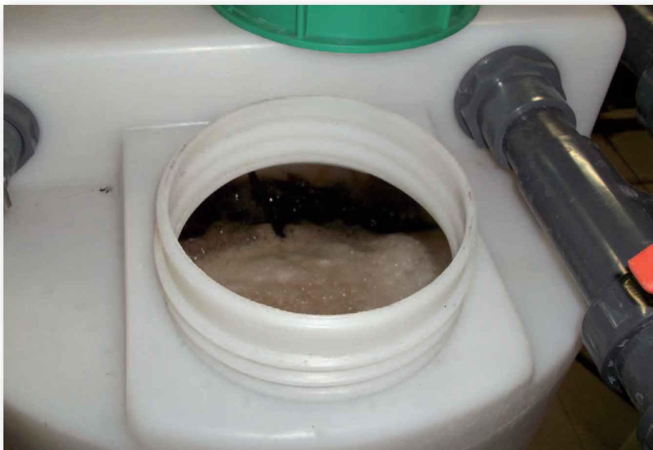
Proces oksydacyjnej regeneracji w fazie rozpuszczania i wypłukiwania resztek koagulantu
