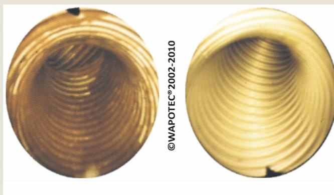
Rys. 4 +5 Biofilm – zakażona rura (po lewej), rura po myciu DesoPur® (w środku), rura ze stali szlachetnej ( po prawej).
