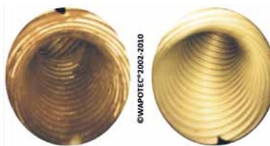
♦ ZANIECZYSZCZENIE RURY BIOFILMEM PRZED (PO LEWEJ) I PO MYCIU OKSYDACYJNYM (PO PRAWIEJ)
